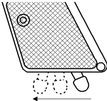
←方向にレバーを動かすと、撃鉄が紙雷管を叩く強さが高まります。
